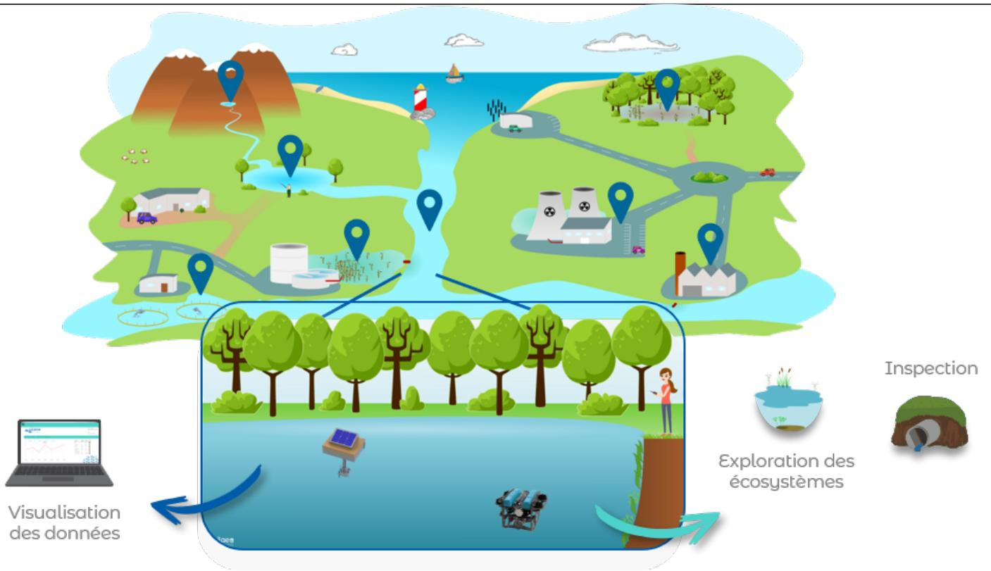
Notre **station de surveillance** est développée dans le but de suivre la qualité des eaux continentales en continu. La station est capable d'embarquer divers capteurs de paramètres physico chimiques, équipés selon vos besoins. Cette station de surveillance est flottante, autonome et retransmet les données relevées à distance.
